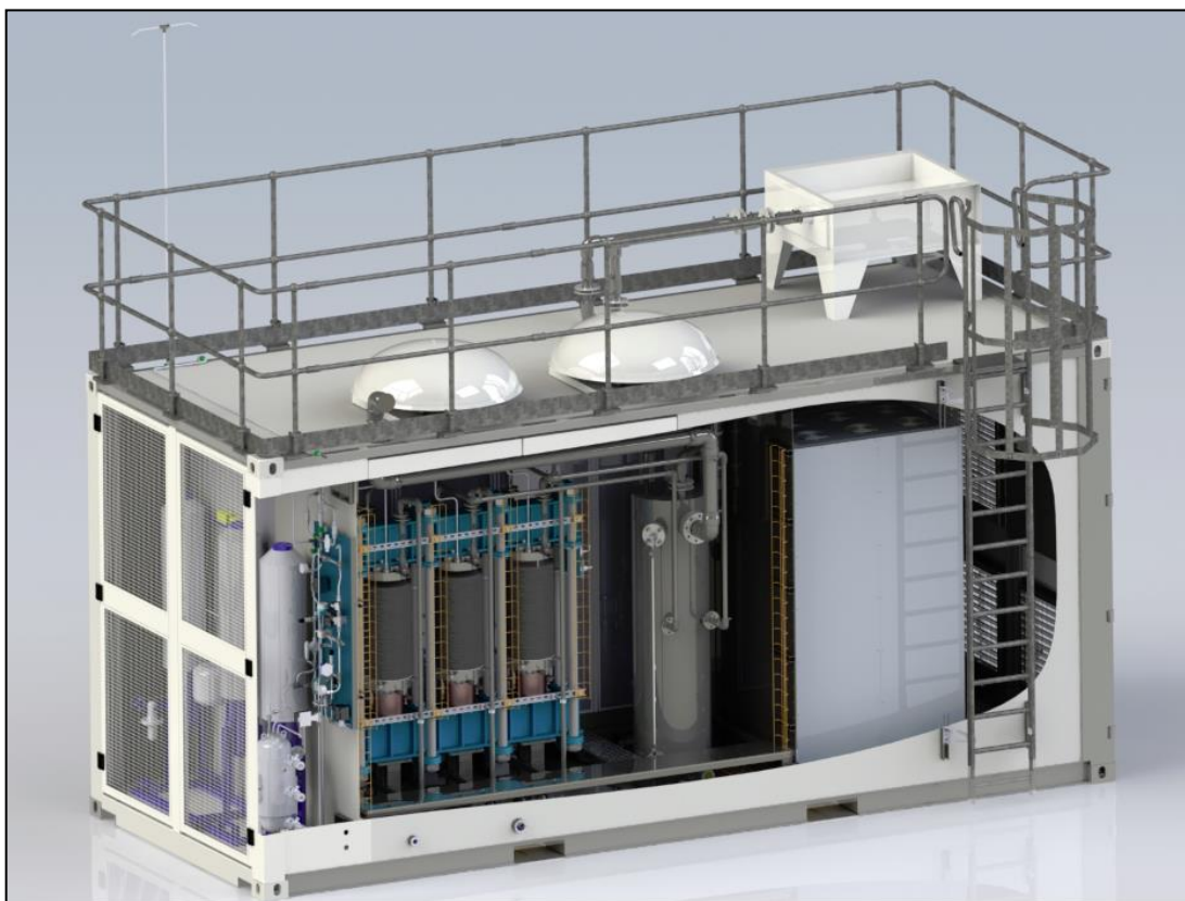
Obr. 15 PEM elektrolytická jednotka o výkonu 150 kW a výrobě vodíku až 3 kg/h v německém Ibbenbürenu (9)
